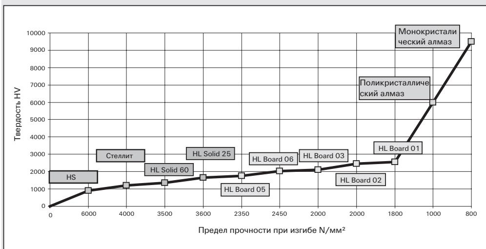
Исходя из данных графика, можно заключить, что рост твердости происходит при снижении предела прочности при изгибе. Иными словами: „Чем тверже материал зуба, тем больше угол заострения.“
